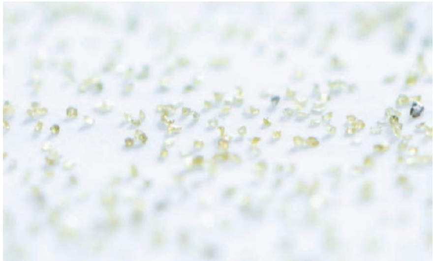
Bild 4 Friction Inserts mit Partikeln in der Größe 115 µm und 20 % Flächenbelegung. (Bild: Freudenberg Performance Materials)
